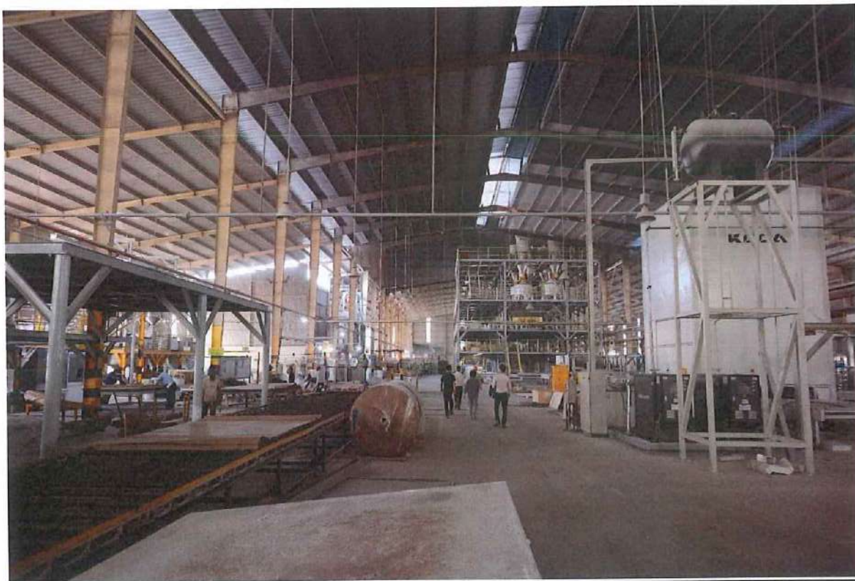
Hệ thống tháp sấy phun và dây chuyền chuẩn bị bột liệu nạp khuôn
